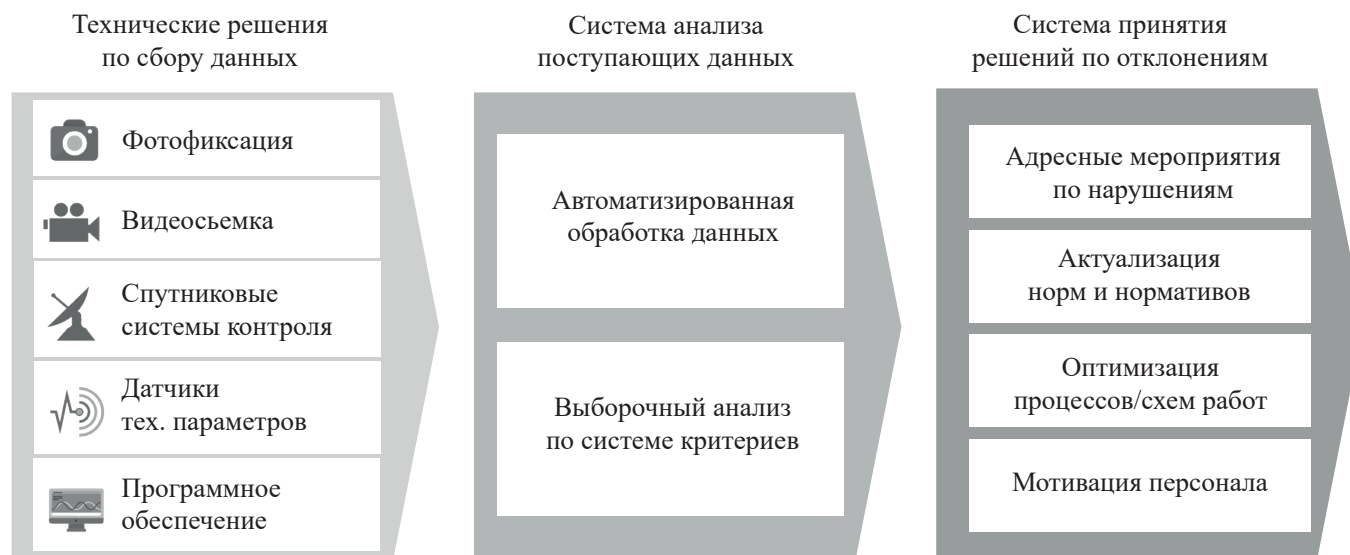
Рис. 1. Схематичная интерпретация и алгоритм работы системы мониторинга процессов и трудозатрат
